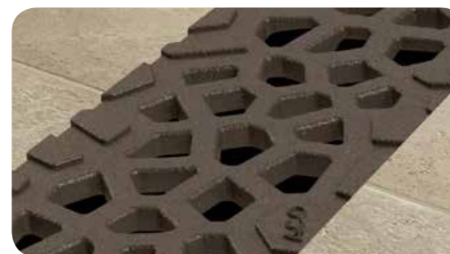
Grille Voronoï : B 125 Largeur 100 mm – Accès PMR Marquage CE – NF EN 1433
