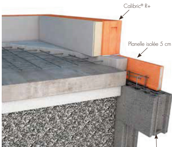
Utilisation de la Calibric® R+ + planelle isolée de 5
