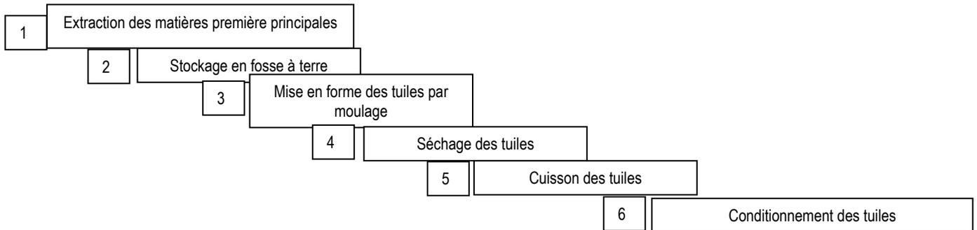
Schéma décrivant le procédé classique de fabrication des tuiles à emboitement
