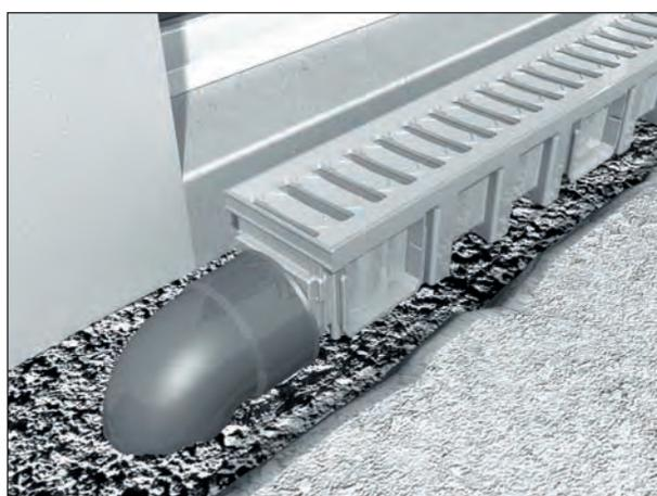
Raccorder le premier élément de caniveau au réseau.
