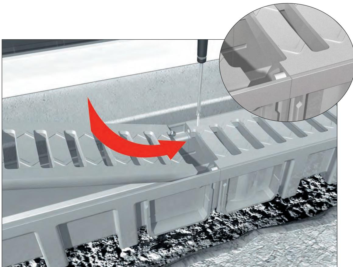
Mettre les grilles en place, **s'assurer de l'alignement entre la grille et le caniveau** afin d'éviter les éventuelles problèmes de dilatation et les visser si nécessaire.
