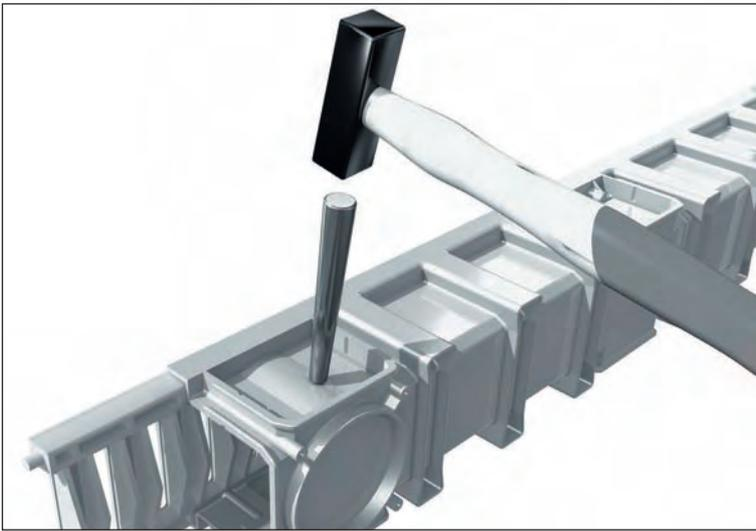
Désoperculer les passages nécessaires en prenant appui sur une grille et mettre la pièce de raccordement en place.
