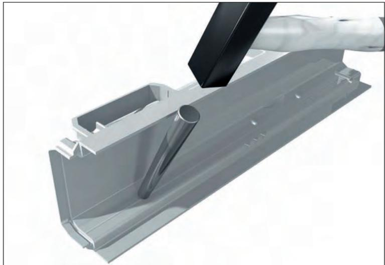
Sur le modèle CAB773, désoperculer les sorties latérales par l'intérieur ou la sortie verticale à l'aide d'une scie cloche (ø 98 mm maxi).
