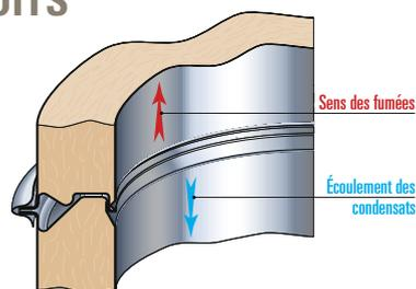
Les éléments de conduits sont emboîtés, afin d'assurer l'étanchéité parfaite aux fumées et aux condensats. Le maintien des deux pièces est assuré par un collier d'assemblage.
