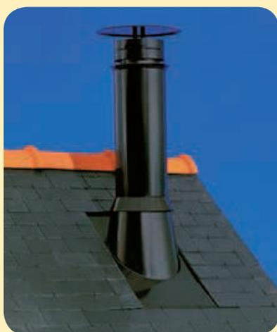
Les conduits de fumée polycombustibles isolés INOX-GALVA et INOX-INOX sont dix fois plus légers que le traditionnel. Ils permettent des dévoiements à 45° (coudes à 15, 30 et 45°) et sont parfaitement bien adaptés à la structure légère des charpentes modernes. L'isolation, d'épaisseur et de densité optimum pour chaque diamètre de conduit, maintient une température de fumée idéale et garantit le meilleur fonctionnement de l'appareil de chauffage.
