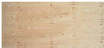
Avec défauts ouverts
