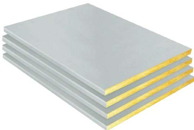
Panneau rigide en laine de verre revêtu d'un pare-vapeur en kraft aluminium sur une face, renforcé de deux voiles de verre et rebordé sur deux côtés.
