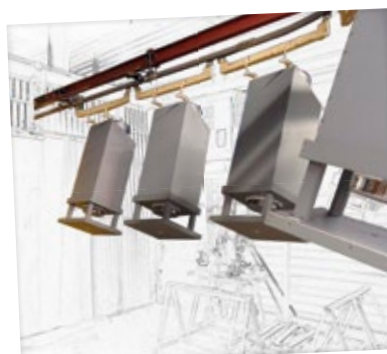
Cabines de peinture et de crépi
