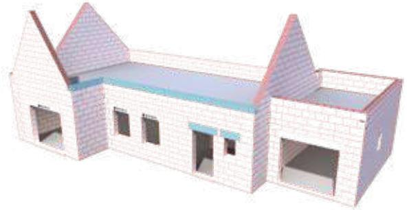
Les accessoires rectifiés sont montés au mortier joint mince ou à la colle fix'bric selon le domaine d'emploi de la brique mère associée.
