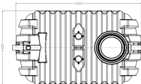
Fosse toutes eaux en PEHD (Polyéthylène à Haute Densité) en amont d'une filtration traditionnelle (fosse munie du préfiltre PF17 et du connecteur sécurisé CPS)
