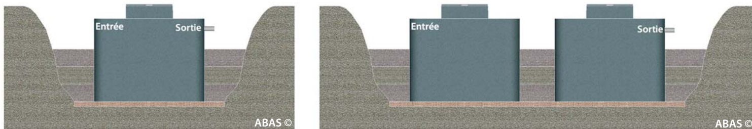
Figure E : Remblaiement par passes successives de 30 à 50 cm
