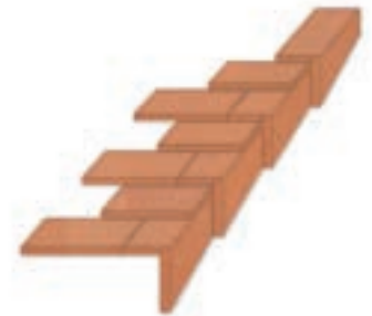
La rive à rabat se pose 1 rang sur 2 à la place de la demi-tuile.
