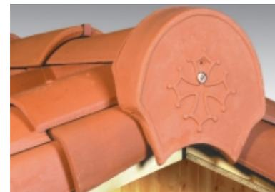
Emploi des tuiles sous-faîtières 2/3 pureau et rives rondes individuelles droite et gauche. Fixation du fronton par vis et rondelle d'étanchéité.
