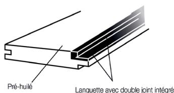
**Navylam+** est un système unique pour une pose de parquet "pont de bateau" facile et plus rapide. Les lames sont déjà **pré-huilées** et munies d'un **double joint intégré**. Fini le ponçage, le huilage ou encore la pose des joints, il suffit désormais de déposer un peu de colle sur les languettes et d'emboîter les lames pour obtenir un parquet fini et parfaitement étanche.
