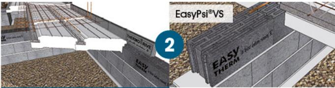
**Plancher bas sur vide sanitaire à poutrelles et entrevous polystyrène**
