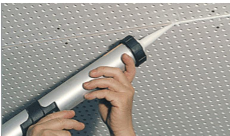
Pistolet pneumatique pour cartouche Jet Filler avec embout
