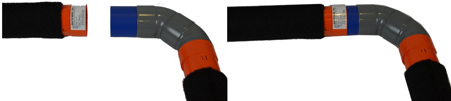
FIGURE N°23 : RACCORDEMENT DU DRAIN BATIFIBRE SN4 LORS D'UN CHANGEMENT DE DIRECTION A 90° A L'AIDE DE DEUX ACCESSOIRES PVC Ø100 A 45° MF
