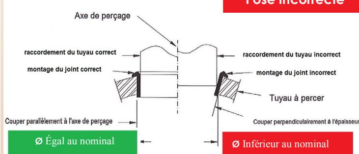
Le perçage s'effectue avec la scie cloche PIQU'O® correspondante au diamètre du joint.
