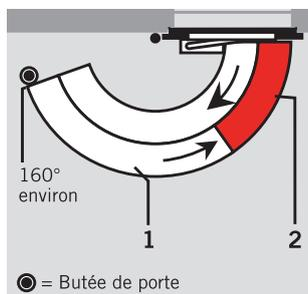
Les réglages hydrauliques sont ajustables en continu par deux vis indépendantes l'une de l'autre.
