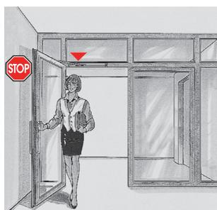
Pour les applications particulières, il est fortement conseillé d'installer une butée de porte, et /ou le freinage hydraulique à l'ouverture ( TS 90 Impulse BC).
