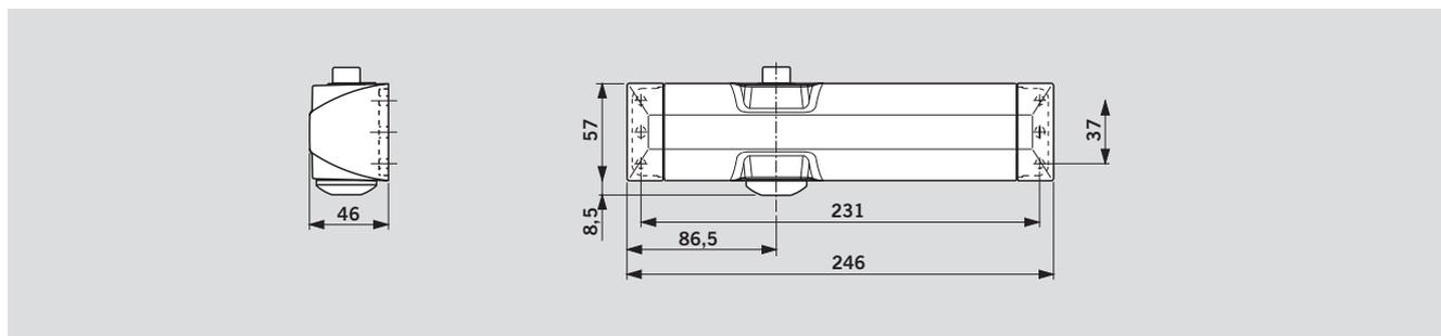
Les glissières avec régulateur de fermeture G-SR (montage côté paumelles) et G-SR/BG (montage côté opposé aux paumelles) sont conçues pour les portes à deux vantaux.
