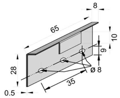
Fig.13 :Clips fixation en inox Vis
