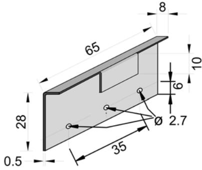
Fig.12 :Clips fixation en inox pointes
