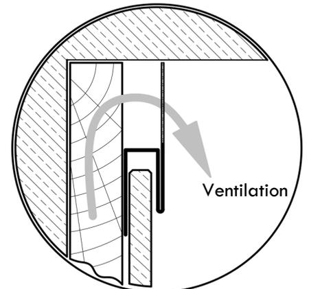
■ **Fig. 19 et 20 : Traitement des linteaux (dessus des menuiseries) : Larmier ventilé de 65**
