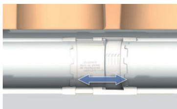
NOTA : les raccords à coller ne doivent pas être mélangés avec les raccords à joint.
