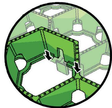
Système d'ancrage et de verrouillage intégré.
