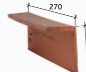
Rive droite 17 (5 par ml au pureau de 100 mm) Réf. 520.44
