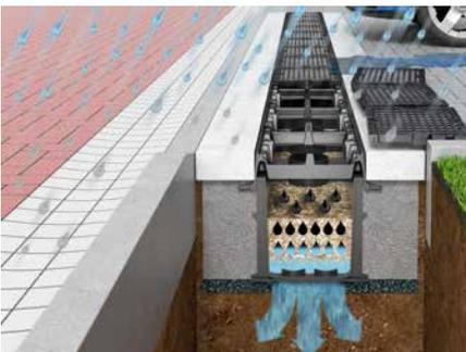
Combinaison d'un caniveau d'infiltration
