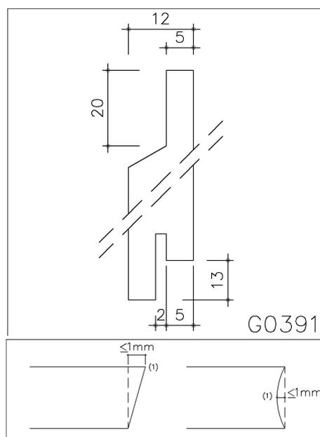
Les dimensions de la rainure et languette sont purement indicatives. Ce sont des dimensions nominales qui sont soumises à des tolérances.
