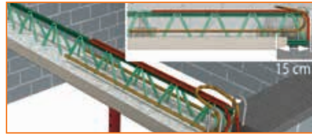
4 Mise en place des aciers complémentaires.
