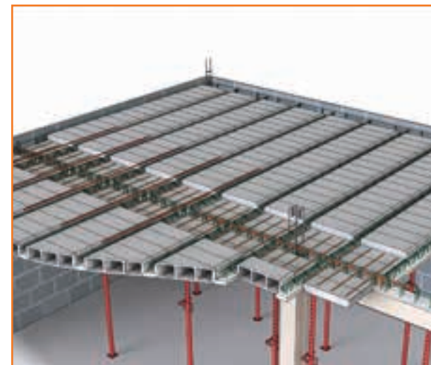
3 Pose des aciers complémentaires (treillis soudé, chapeaux, aciers de couture éventuels).
