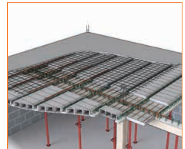
4 Coulage du plancher Retrait des étais : attendre 28 jours ou s'assurer que le béton a une résistance d'au moins 25 MPa.
