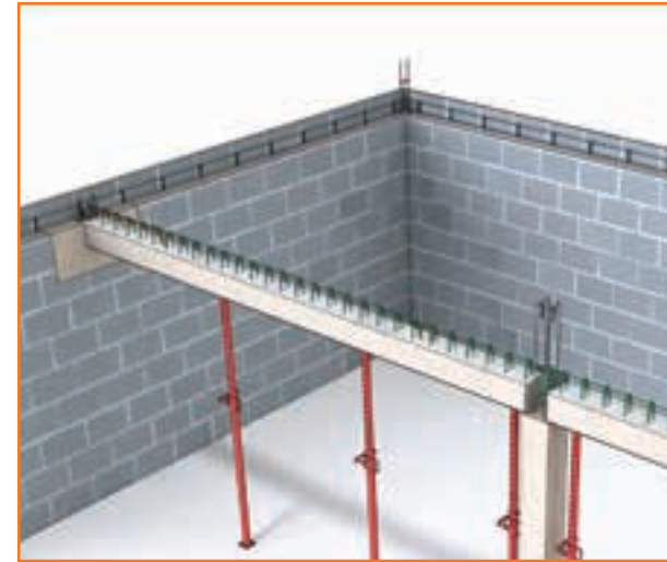
1 Préparation des appuis. Pose des PBSE. Etalement (1 tous les 1,50m). Clavetage des extrémités de la PBSE.
