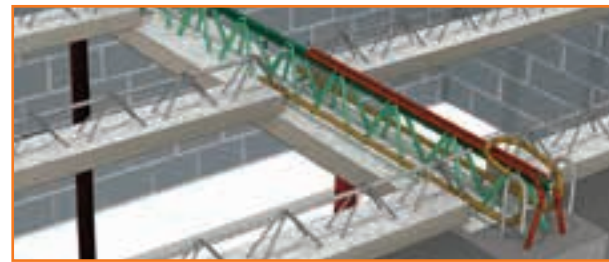
6 Pose des poutrelles.
