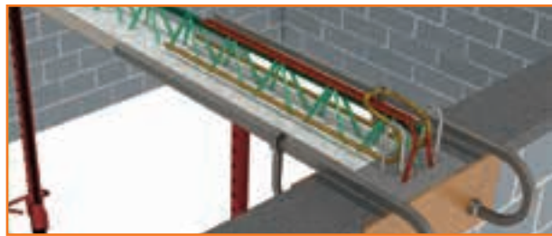
5 Coffrage + clavetage de la poutre.
