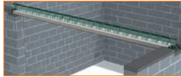
2 Mise en place. Appuis sur maçonnerie = 5 cm.
