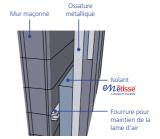
Ci-dessus, un exemple de pose en mur maçonné et ossature métallique avec aménagement d'une lame d'air.
