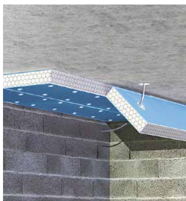
Fig. 21 : Découpe du panneau pour passage des canalisations ou gaines électriques
