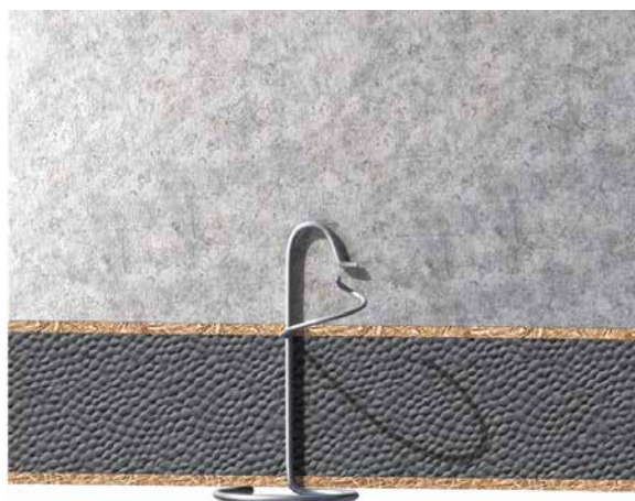
Fig. 6 : Agrafe métallique à relever sur chantier
