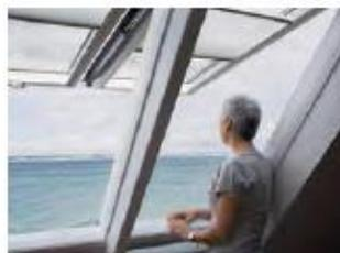
Les fenêtres à ouverture par projection peuvent être ouvertes en continu jusqu'à un angle de 45°. La poignée placée en bas permet de manœuvrer aisément la fenêtre.
