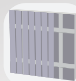
Pose verticale double lambourrage
