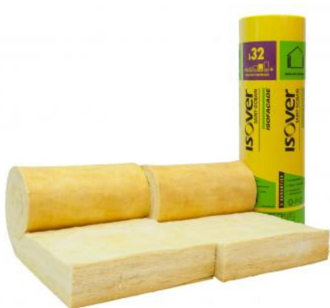
Panneau à dérouler de laine de verre semi-rigide revêtu d'un voile de verre pour l'isolation thermo-acoustique des murs par l'extérieur sous bardage rapporté. L'épaisseur 80 mm est prévue pour l'isolation complémentaire entre les ossatures bois du bardage rapporté.
