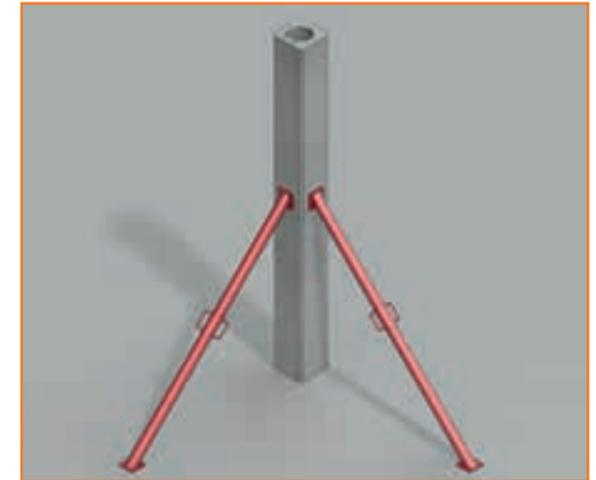
**4** Positionner le poteau verticalement et l'étayer. Après la mise en œuvre éventuelle des éléments préfabriqués, remplir l'intérieur du poteau.
