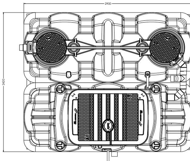
Filtre compact composé de 2 cuves en PEHD (Polyéthylène à Haute Densité) : 1 fosse toutes eaux (munie du préfiltre PF17 et du connecteur sécurisé CPS) et 1 filtre naturel végétal composé de fragments de coco pour filtration des eaux usées domestiques
