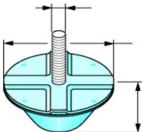
Accessoire de suspension résilient monté sur plot caoutchouc améliorant les performances acoustiques des plafonds
