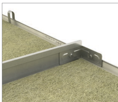
Afin de s'assurer de la perpendicularité du Rockfon System T24 X, il est recommandé d'utiliser une pièce de raccord universelle - angle 90° sur chaque profilé porteur et toutes les deux entretoises.
