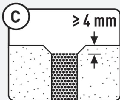
Le joint doit être à niveau avec le bas du chanfrein (minimum 4 mm sous la surface du pavé).
