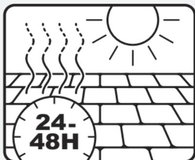
Afin d'assurer sa bonne cohésion et sa résistance à long terme, le Sable de jointoiment doit impérativement sécher complètement avant d'être exposé à la pluie (24 à 48 heures minimum).
