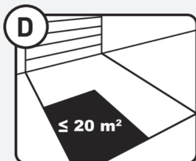
Il est **IMPÉRATIF** d'arroser de bas en haut par section maximum de  $20 \text{ m}^2$  à la fois et de s'assurer que le mouillage de la section soit terminé avant de passer à la section suivante.
