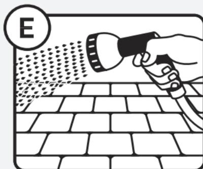
Régler le pistolet à "douche". **Mouiller une première section, sans déplacer le sable, jusqu'à refus (de 30 à 45 s). Passer à la section suivante.**
