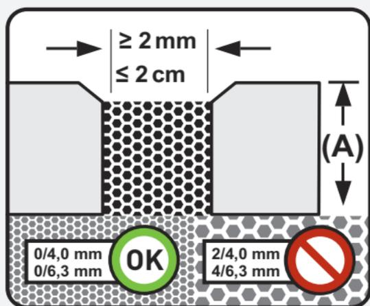
**Largeur minimale des joints : 2 mm**
