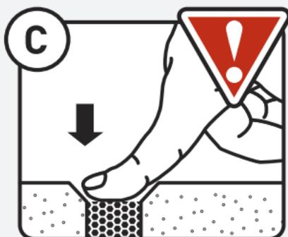
Un compactage bien effectué ne permet pas qu'un doigt s'enfonce dans le sable tout juste mis en place.
