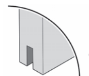
Rainure de 6 mm x 16 mm pour guidage de la porte.
