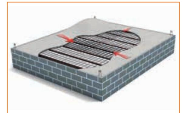
**5** Coulage de la table de compression. Répartir le béton en partant des appuis vers le centre des poutrelles.
