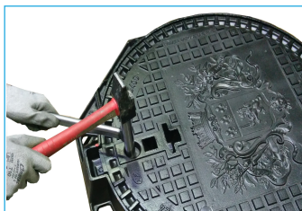
2 Défoncer la pastille avec un outil de surface plane Ø 20mm maxi de type emporte pièce
