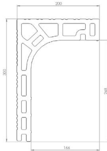
Figure n°5 détail terre cuite caisson monobloc
