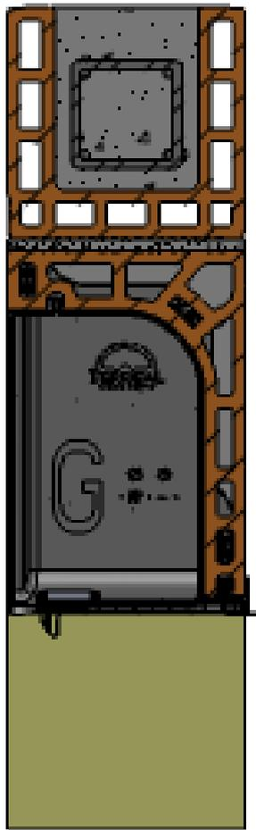
Figure n°9 coupe de mise en œuvre avec maxi linteau
