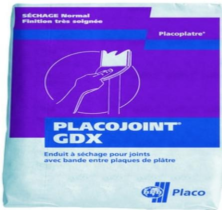
Enduit poudre à séchage permettant le traitement manuel ou mécanique des joints avec bande papier. Le redoublement des joints se fait après durcissement complet de l'enduit et dépend essentiellement des conditions climatiques (12 à 48 heures). Utili
