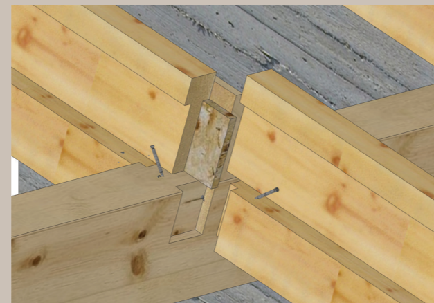
2. Assemblage des poutres INOPANNE par entaille et vis SFS
