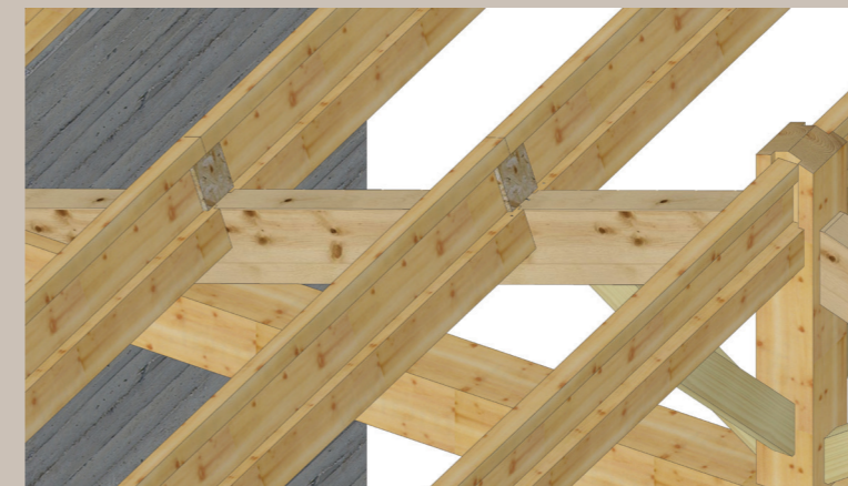
3. Connexion des deux poutres par renforts d'âmes
