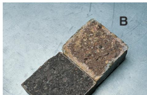
Fig. 2B - Essais de pénétration de l'ion chlorure (UNI 9944). L'échantillon A revêtu de Mapelastic n'a pas été pénétré; l'échantillon B, tel quel, présente un front d'avancement de plusieurs millimètres.
