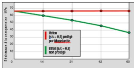
FIG. 4 : EFFET DU MAPELASTIC SUR LA DÉGRADATION MÉCANIQUE DU BÉTON CAUSÉE PAR LES SELS ANTIGELS À BASE DE CHLORURE DE CALCIUM
