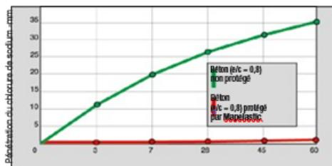
FIG. 3: EFFET DU MAPELASTIC SUR LA PÉNÉTRATION DU CHLORURE DE SODIUM DANS UN BÉTON POREUX
