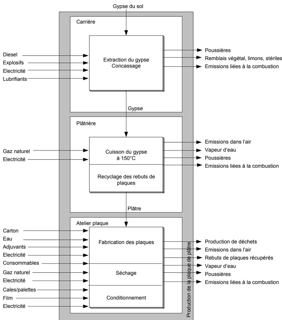
Figure 1 : Etapes de production des plaques de plâtre
