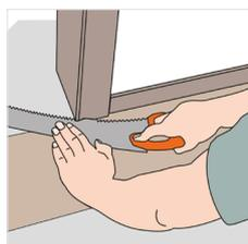
Les encadrements de porte en bois doivent être suffisamment raccourcis pour positionner en-dessous une lame et un support. Posez un panneau face vers le bas à côté de l'encadrement de porte.
