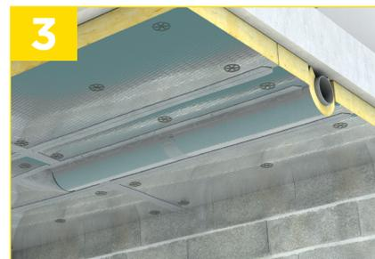
Pour un tuyau d'évacuation inférieur à 40 mm, vous pouvez l'inclure dans l'isolation.
