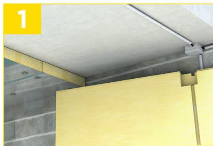
Pour un boîtier électrique ou un tuyau reportez la dimension sur le Panodal. Ne coupez que l'épaisseur nécessaire afin de laisser une épaisseur d'isolant maximale.
