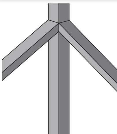
Aux angles et aux extrémités de la clôture ainsi que **tous les 25 à 30 m**, il est nécessaire de **poser un poteau à encoches équipé de jambes de force**.
