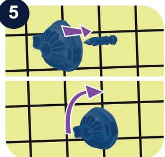
Il ne vous reste plus qu'à fixer l'écrou de verrouillage en effectuant un quart de tour.
