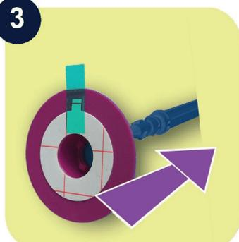
Positionner les cloches violettes sur les pointes des suspentes pour maintenir l'isolant. Attention, veillez à bien les clipser.
