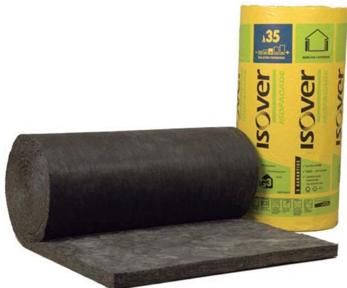
Panneau à dérouler en laine de verre noire semi-rigide revêtu d'un voile de verre pour l'isolation thermo-acoustique des murs par l'extérieur avec des bardages ajourés ou translucides.
