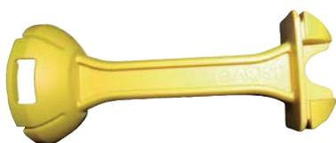
Rallonge en composite se clipsant entre la clé de la suspente Intégra 2 et la fourrure métallique, pour aménager un espace technique de 10 cm en plafond horizontal.
